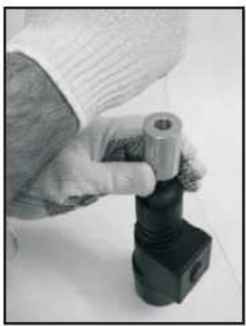
Un manual de acción cartucho de extracción
