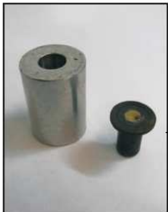
Dispositivo saca-cartucho y cartucho amarillo detonado
